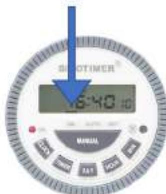
Una volta impostata su ON, collegare il cavo di alimentazione alla presa di corrente e premere il pulsante di accensione su ON; sul Timer si accenderà il led rosso di fianco alla voce ON.
