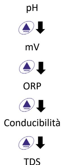
**Nota:** Premendo il tasto
